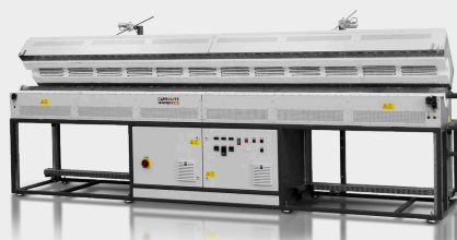
Kundenspezifischer dreizoniger Klapprohrföfen FZS 13/100/4500 mit 4500 mm beheizter Länge, automatischem Aufklappmechanismus und APM Arbeitsrohr
