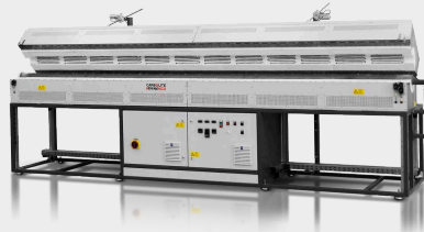
用户定制的三区控温FZS 13/100/4500管式炉，加热长度4500mm，自动开启装置以及铁铬铝工作管。
