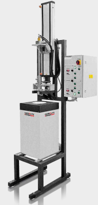
最高温达到1800°C的标准布里奇曼晶体生长炉
