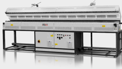
Специально спроектированная трехзонная трубчатая печь FZS 13/100/4500 с длиной зоны нагрева 4500 мм, автоматическим открытием и рабочей трубкой из сплава АРМ
