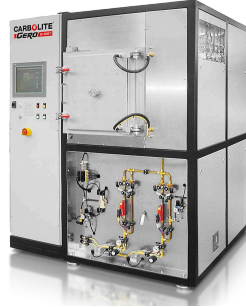
Piec HTK 25 W/22-1G wersja automatyczna 25 L pojemności użytkowej, 2200 °C, Argon
