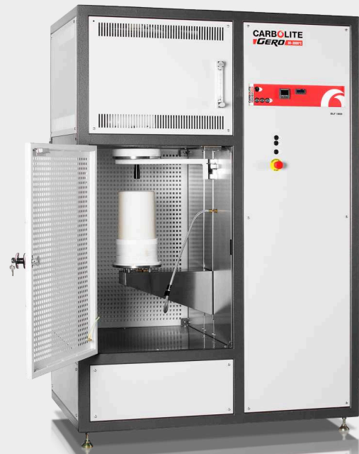
BLF 18/8 s obráceným kelímkem, průtokoměrem plynu a radiačním krytem
