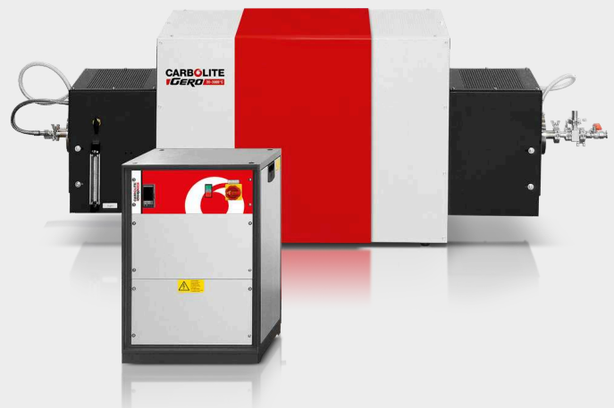
HTRH 17/70/600 com pacote opcional de gás inerte, flanges de alto vácuo e programador E3508P10
