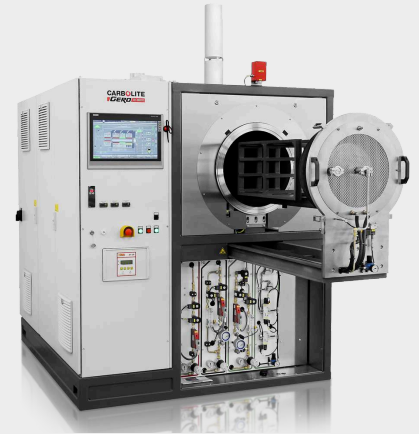
GLO 120/11-IG automático até 1100°C com pacote de hidrogênio opcional e porta de gaveta
