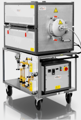
GLO 10/11-IG: Forno compacto de parede quente com retorta de aço inoxidável e retorta inonel opcional (vácuo até 750°C e sob pressão normal até 1100°C)
