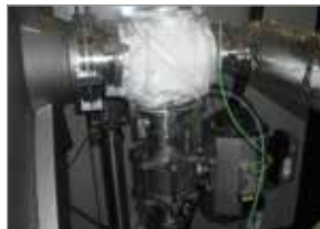
Beheizter Gasauslass, um die Kondensation während des Entbinderns zu verhindern
