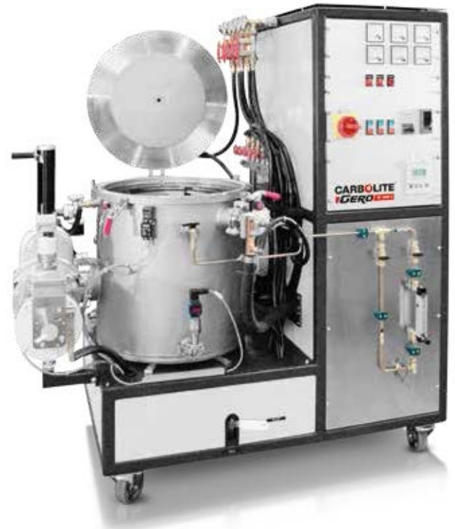
LHTW 200-300/22: Hochtemperaturlaborofen mit einem Durchmesser von 200 mm und einer beheizten Höhe von 300 mm. Die maximale Temperatur beträgt 2200 °C.
