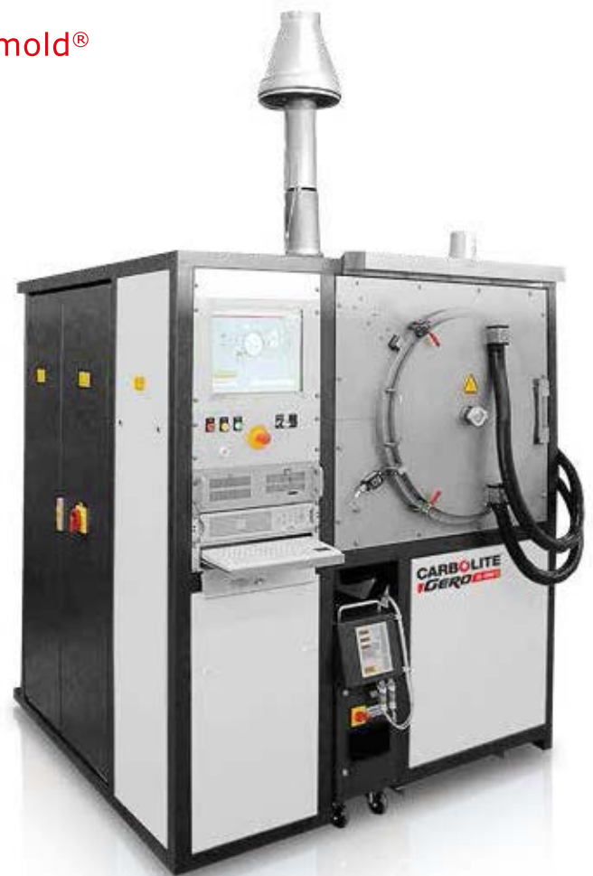
EBO 120/1,5 Ofen für katalytische Entbinderung. Nutzbares Volumen 120 l. Wasserbeheizte Kammer bis maximal 150°C.
