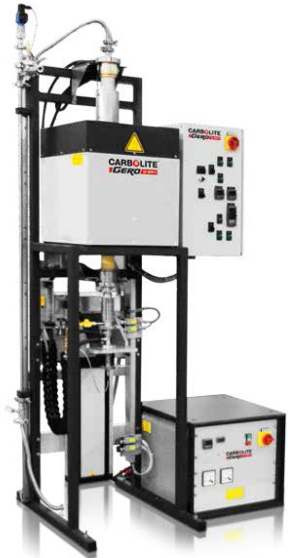
BV-HTRV 70-250/18: Anlage zur Kristallzucht nach Bridgman. Die beheizte Höhe beträgt 250 mm, die maximale Temperatur beträgt 1800 °C. Der Ofen ist mit einer Vorvakuumpumpe ausgestattet.
