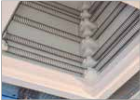
Innenaufbau der Haube des HB mit CrFeAl-Heizdrähten. Die Maximaltemperatur dieses Ofens beträgt 1300°C.
