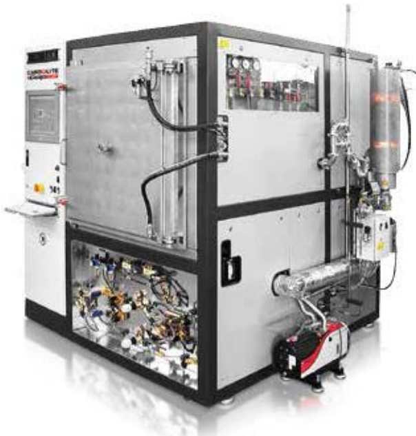
HTK 80 GR/30: Kammerofen der SERIE 3000 mit einem nutzbaren Volumen von 80 l und einer maximalen Temperatur bis 3000°C.
