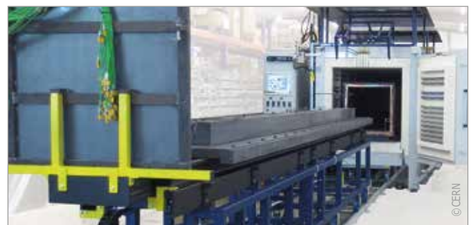
System zum Be- und Entladen des Ofens
