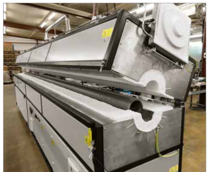
Klapprohrofen mit einer beheizten Länge von 5,5 Metern und einer maximalen Temperatur bis 1000 °C
