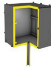
Graphit-Retorte mit zentralem Gasauslassrohr
