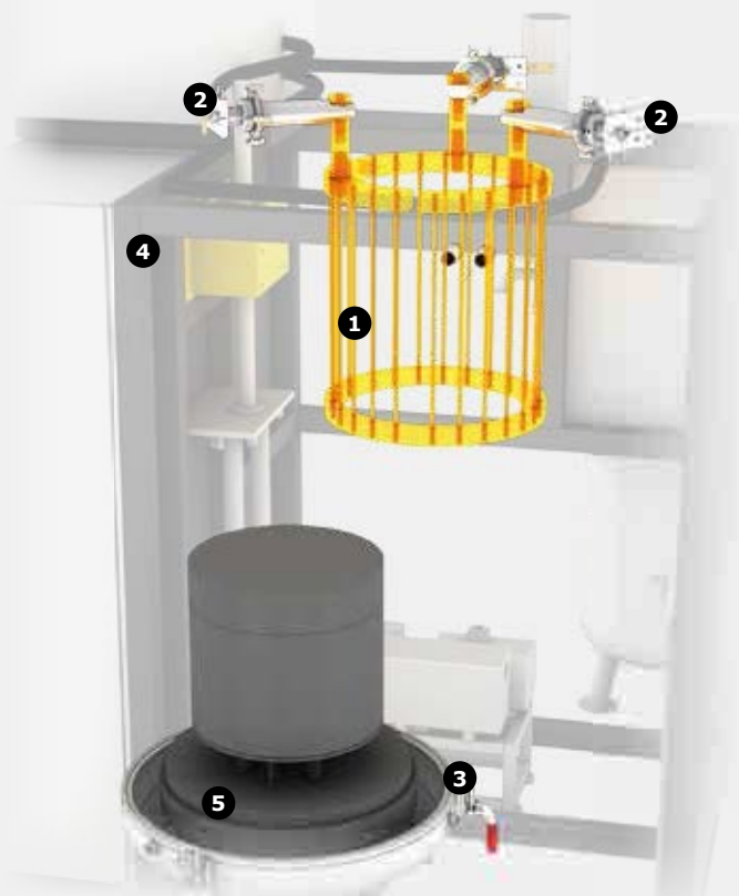
Bild eines Mantelheizers aus Graphit. Das Heizelement besteht aus mehreren symmetrisch angeordneten Graphitstäben, damit eine möglichst homogene Temperaturverteilung erreicht wird.
