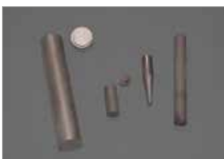
Graphit Tiegel für die Kristallzucht nach Bridgman
