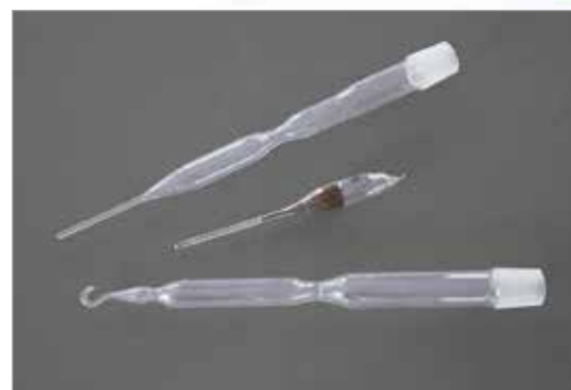
Das Bild zeigt eine Bridgman-Ampulle mit einer Spitze und einem Stab (oben). Die durch Schmelzen verschlossene Ampulle ist in der Mitte abgebildet. Die Spitze dient zur Bildung von Keimen. Die untere Ampulle ist mit einem Haken versehen.
