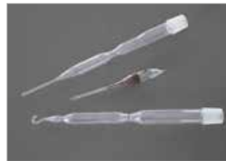
Quarz-Röhrcchen für die Bridgman-Kristallzucht oder zur Kristallzucht aus der Dampfphase
