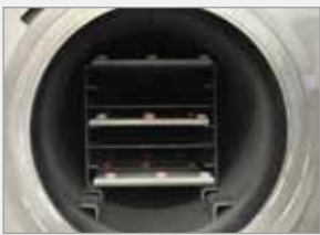
Retorte mit eingesetzten Auflageblechen für die Proben
