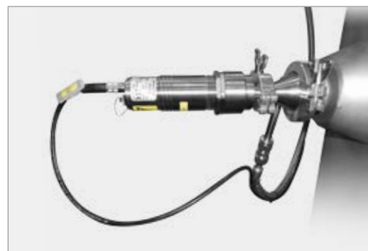
Mit dem Pyrometer können auch höchste Temperaturen von 3000 °C gemessen werden. Das Pyrometer wird auf einen definierten Punkt im heißen Bereich fokussiert. Die Wärmestrahlung wird durch ein Quarzglas hindurch auf den Sensor des Pyrometers fokussiert. Ein Gaseinlass spült das Quarz-Fenster. Das Pyrometer kann mit dem Schiebethermoelement justiert werden.
